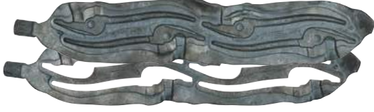
(2) Çiftli dövme kalıbında kor halinde dövülür. Çapaklar bir eksantrik pres altında ortadan kaldırılır.
