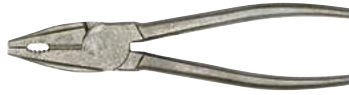
(6) Hareketli ve sabit Pense kolları birbirine perçinlenir. Penselerin mafsal kısmının boşluk olmaksızın ancak düzgün hareket eden bir konumda olması «tek elle» yapılan güvenli çalışmalar için gerekli bir şarttır.
